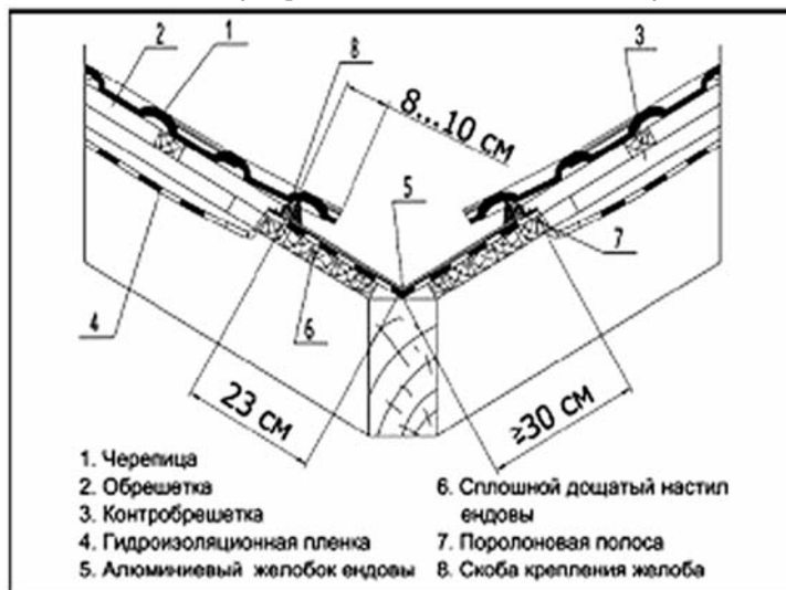
Устройство деревянного настила под желобок ендовы
