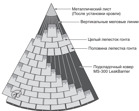
Рисунок 6. Установка кровли на конус.
